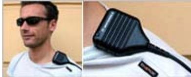
Via flexiblem Spiralkabel wird das Lautsprechermikrofon an das Motorola Funkgerät angeschlossen und mittels Klipp an Ärmel, Brusttasche oder Kragen befestigt. Bester Tragekomfort und Sprachausgabe in Kopfnähe sind die Vorteile dieses Systems.
